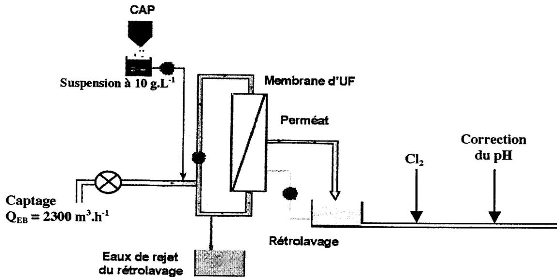
Installation de 8 blocs de 28 modules chacun. Surface totale développée : 14 000 m<sup>2</sup>.
