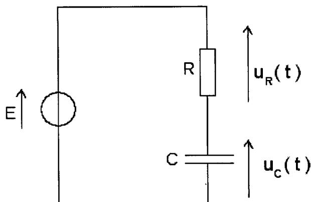
5.1. Établir l'équation différentielle régissant l'évolution temporelle de  $u_c(t)$ , tension aux bornes du condensateur.
