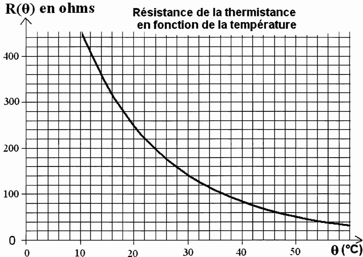
1- À partir de cette caractéristique, déterminer la sensibilité « s » de la thermistance (variation de sa résistance en ohms par degrés Celsius ( $\Omega \cdot ^\circ\text{C}^{-1}$ )) à la température  $\theta = 32^\circ\text{C}$  (préciser la méthode utilisée).
