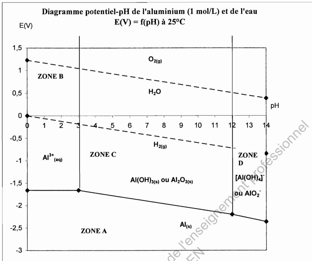
Au niveau de l'anode de la cellule d'électrocoagulation, l'aluminium réagit spontanément en présence d'oxygène et d'eau pour former une couche d'oxyde. On se demande alors comment dans la pratique l'EC peut être efficace pour les pH intermédiaires [5 à 8].
