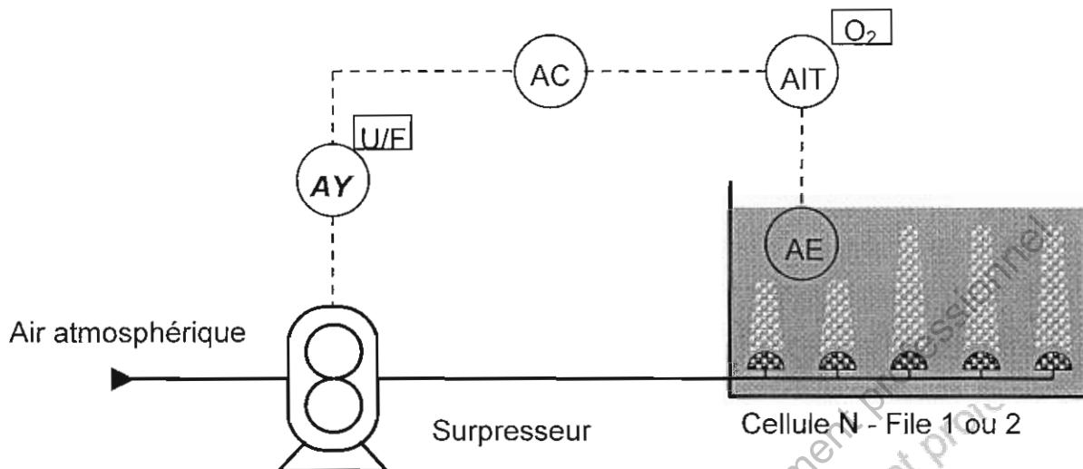
« AC » est en fait l'API de l'usine qui exécute un algorithme de régulation PID pour chaque cellule. La consigne est de 4 mg/L pour les cellules N. La mesure de la concentration en oxygène dissous est transmise à l'automate par signal 4-20 mA. L'étendue de mesure est 0 à 5 mg/L. L'interface d'entrée analogique de l'automate produit le mot MES\_O2\_Nx pris en compte par l'algorithme, avec :  $MES\_O2\_Nx \in [0 ; 10000]$ .
